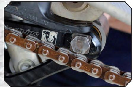
Die „low“ Variante reduziert die Sitzhöhe, um ganze 3 cm bei unserer Husqvarna FE 350 (Bj. 2020). Damit ist es besonders einfach, mit beiden Füßen stabil auf dem Boden zu stehen.
