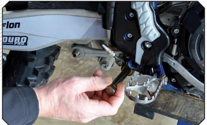
Nun können wir den Bolzen ohne Problem herausnehmen. Dazu am besten das Motorrad auf einen stabilen Mittelständer stellen und mit der Hand die Schwinge leicht anheben. Somit wird der Druck auf die Umlenkung reduziert und beide Bolzen können einfach entnommen werden
