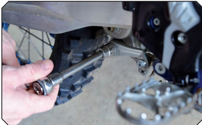
Zuerst lösen wir die Muttern von der Umlenkung, am besten mit einem Ratschen- bzw. Ringschlüssel
