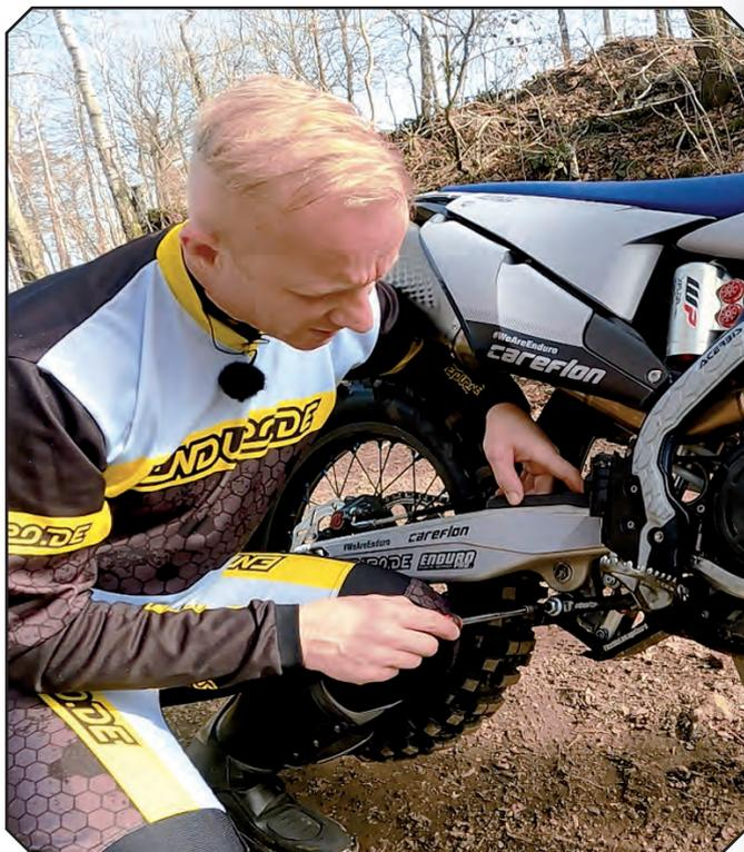
Für eine Änderung der Einstellung stellen wir das Motorrad auf den Seitenständer und halten es mit der linken Schulter unter dem Auspuffenschalldämpfer fest. Nun können wir mit dem Ringschlüssel die Mutter vom Exzenter lösen und mit dem Inbusschlüssel den Exzenter auf die gewünschte Position drehen. Jetzt die Mutter wieder festziehen und fertig
