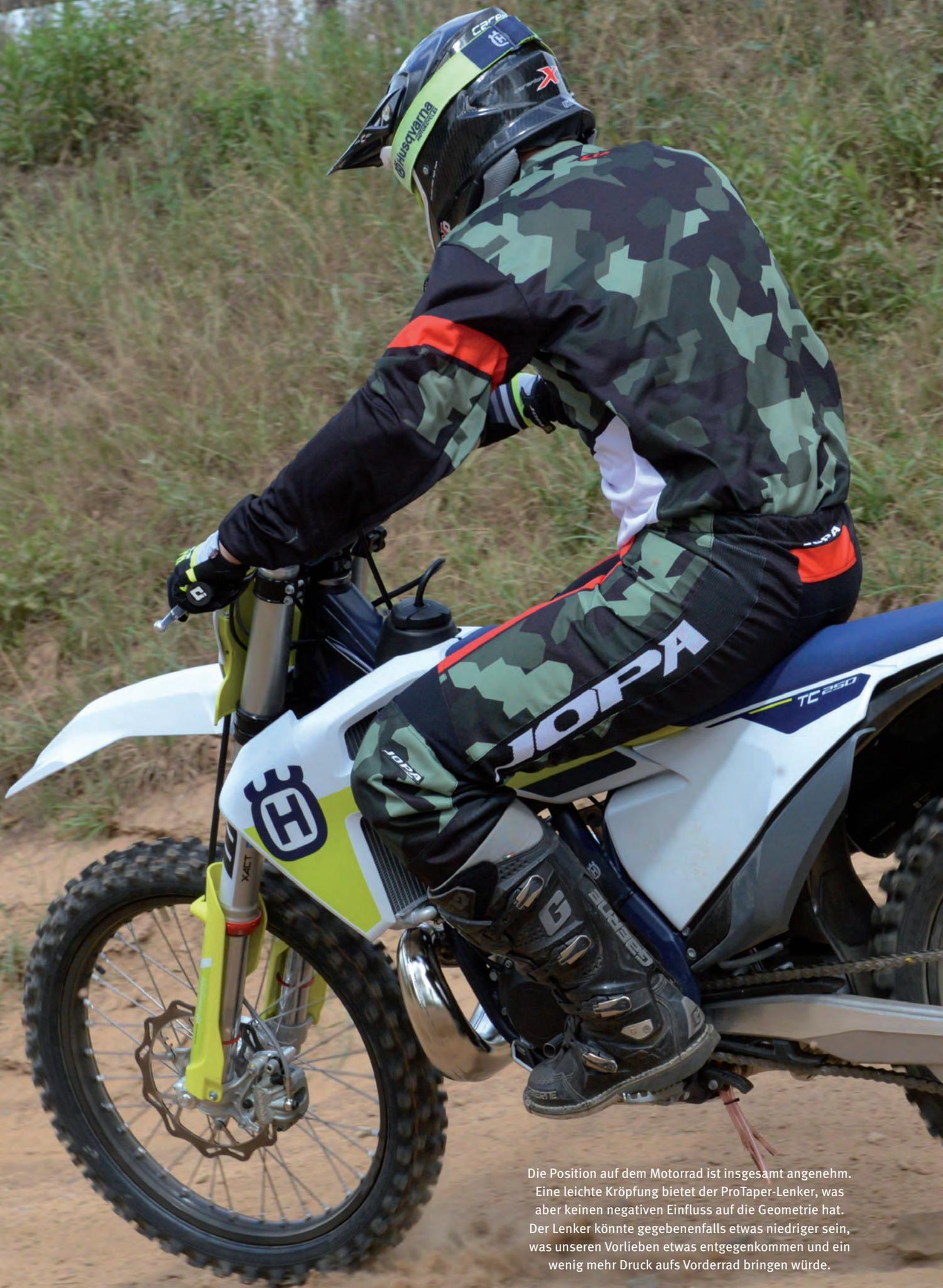
Die Position auf dem Motorrad ist insgesamt angenehm. Eine leichte Kröpfung bietet der ProTaper-Lenker, was aber keinen negativen Einfluss auf die Geometrie hat. Der Lenker könnte gegebenenfalls etwas niedriger sein, was unseren Vorlieben etwas entgegenkommen und ein wenig mehr Druck aufs Vorderrad bringen würde.
