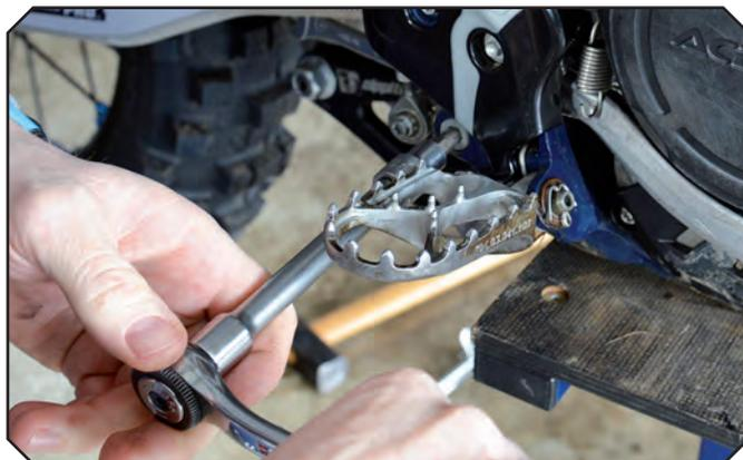
Zu guter Letzt montieren wir den Fußbremshebel. Nicht vergessen, die Mutter mit einer Schraubensicherung einzukleben
