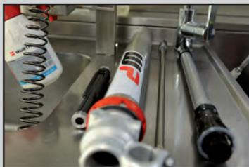
Das komplette Innenleben wird gereinigt und gegebenenfalls die Druck- sowie Zugstufeneinheit mit den einzelnen Shims ebenfalls demontiert
