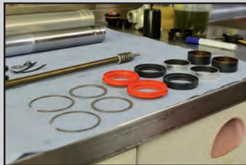
Der komplette Dichtungssatz wird ausgetauscht
