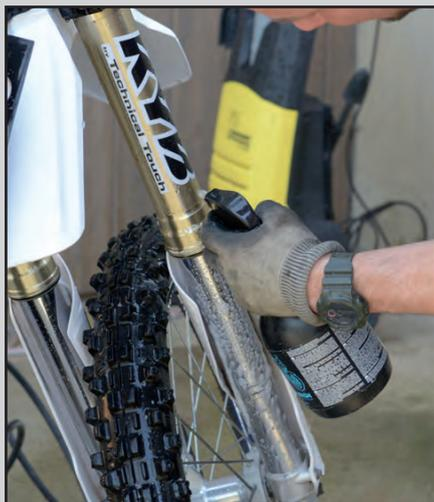
Bevor ein Service an der Telegabel durchgeführt werden kann, sollte eine gründliche Reinigung der kompletten Gabel erfolgen. Eine saubere Telegabel lässt sich einfacher ausbauen und vor allem verhindert man beim Demontieren, dass Schmutz in die Gabel gelangt. Die Reinigung erfolgt mit einem herkömmlichen Motorradreiniger zusammen mit einem Hochdruckreiniger oder kräftigen Wasserschlauch und einer Bürste.
