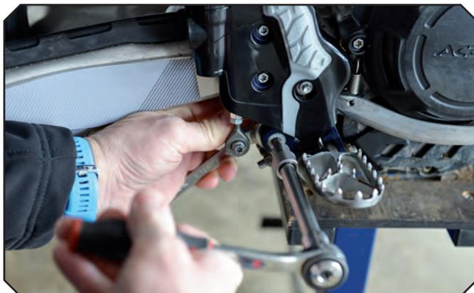
Außerdem haben wir die Halterung vom Fußbremshebel gelöst und entfernt, damit wir etwas mehr Platz für den Umbau haben
