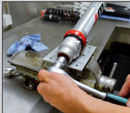
Den unteren Gabelfuß in einen Schraubstock mit Aluminiumklemmen einspannen und die untere Armatur mit einem passenden Werkzeug lösen
