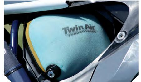
*Innovatives zweiteiliges Verbund-Heckrahmen-Design inklusive einfachem Zugang zum Luftfilter*
