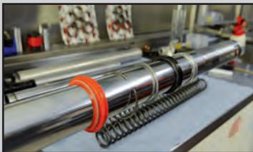
Vom Gleitholm werden die Gleitbuchse, Gleitringe, der Simmering sowie die Staubkappe entfernt
