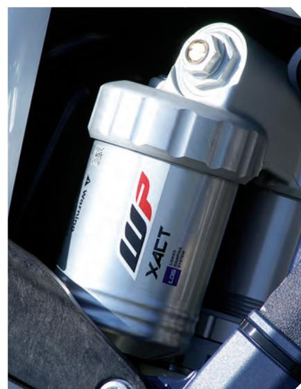
Der WP XACT-Stoßdämpfer verfügt über neue reibungsarme Verbindungs-dichtungen für ein verfeinertes Federungsverhalten und erweiterte Dämpfungseigenschaften
