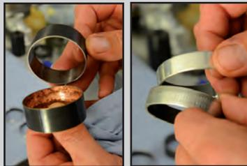
Gleitbuchsen werden auf Schäden überprüft
