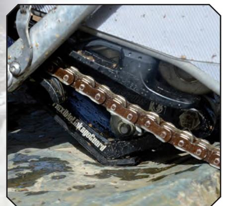
*Das „Flexible Linkage Guard“ bietet neben der Umstellmöglichkeiten auch einen optimalen Schutz der unteren Dämpferaufnahme*
