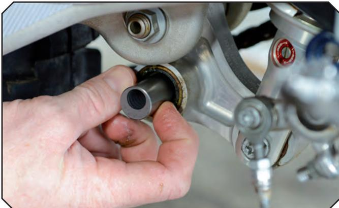
Jetzt wird die neue Hülse eingesetzt und anschließend die dazu gelieferten Arretierungshülsen draufgedrückt. Achtet hierbei genau auf die Übereinstimmung der Bohrungen, sonst kann der Bolzen nicht passend eingesetzt werden
