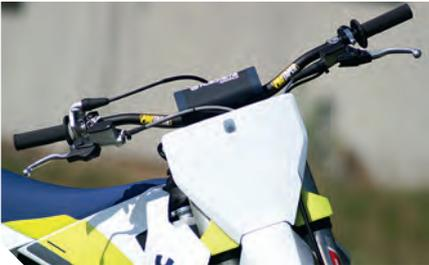
*Ein hydraulisches Kupplungssystem von Magura links und Brembo Bremssystem rechts sind am ProTaper Lenker montiert*
