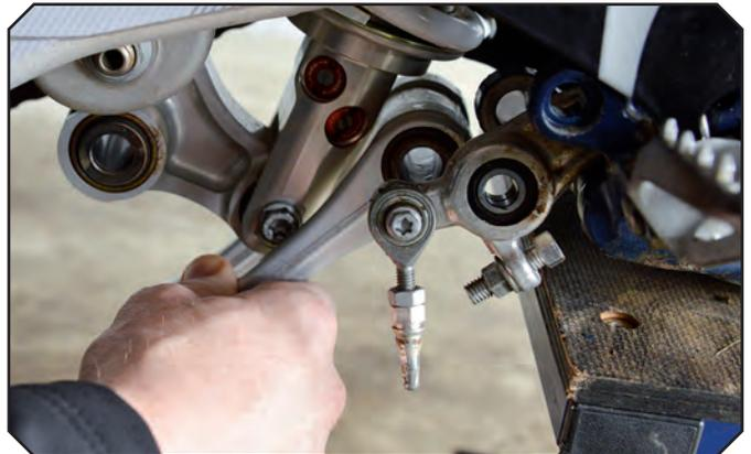
Jetzt kann die Original-Umlenkung entfernt werden
