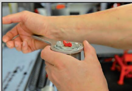
Der Gabelholm wird leicht in einen Schraubstock mit Aluminiumklemmen eingespannt, die obere Einstellarmatur mit einem großen Schraubenschlüssel gelöst und komplett herausgeschraubt
