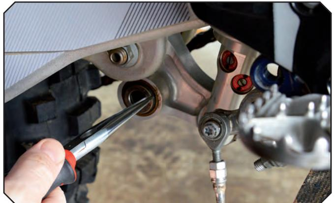
Die Arretierungshülsen mit einer Zange entfernen und das Lager auf Beschädigung und Schmutz überprüfen, gegebenenfalls austauschen
