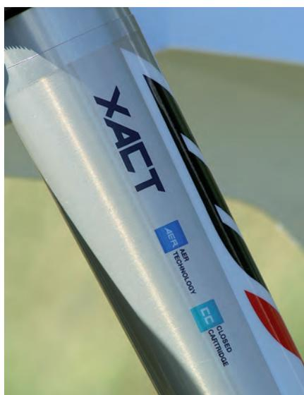
Neue 10 mm kürzere Gabel-Cartridges und Außenrohre bieten eine bessere Steifigkeit für verbesserten Fahrkomfort
