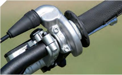
*Die neue rollenbetätigte Drosselklappenbaugruppe bei Zweitaktmodellen bietet eine gleichmäßigere Drosselklappenbewegung und eine verbesserte Haltbarkeit*
