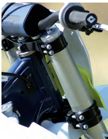
Das neue Mid-Valve-Dämpfungssystem bietet eine verbesserte Dämpfung und eine gleichmäßige Federungsleistung der WP XACT-Gabeln mit AER-Technologie
