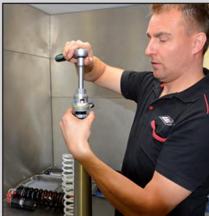
Mit einem Spezialwerkzeug wird die Armatur von der Feder gelöst und vorsichtig entfernt. Hier gilt es, vorsichtig zu sein, da die Feder Druck auf die Armatur ausübt
