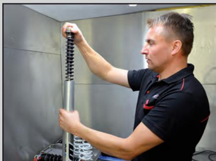
Die obere Armatur ist aus dem Gabelholm herausgeschraubt und muss nun von der Feder getrennt werden
