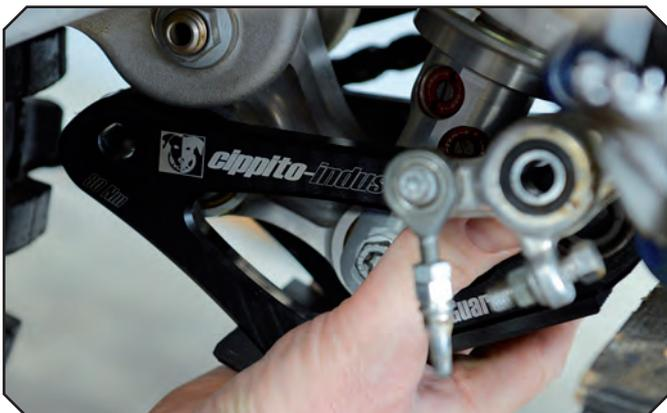
Nun können wir die cippito Umlenkung passend platzieren und den vorderen Bolzen einsetzen. Auch hier wieder leicht die Schwinge anheben, somit kann der Bolzen leichter montiert werden
