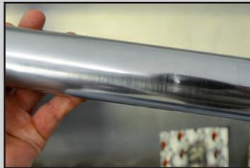
Die Gleitrohre werden auf eventuelle Schäden überprüft und müssen gegebenenfalls ausgetauscht werden
