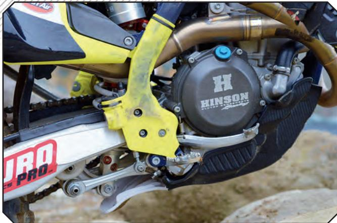
Bei unserem Motorrad ist ein Motorschutz mit integriertem Umlenkschutz montiert. Diesen Schutz mussten wir vorher entfernen, um die Umlenkung auszutauschen
