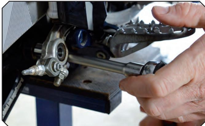
Ebenso muss der vordere Bolzen angezogen werden. Bei Husqvarna wird ein Anzugdrehmoment von 60 Nm empfohlen
